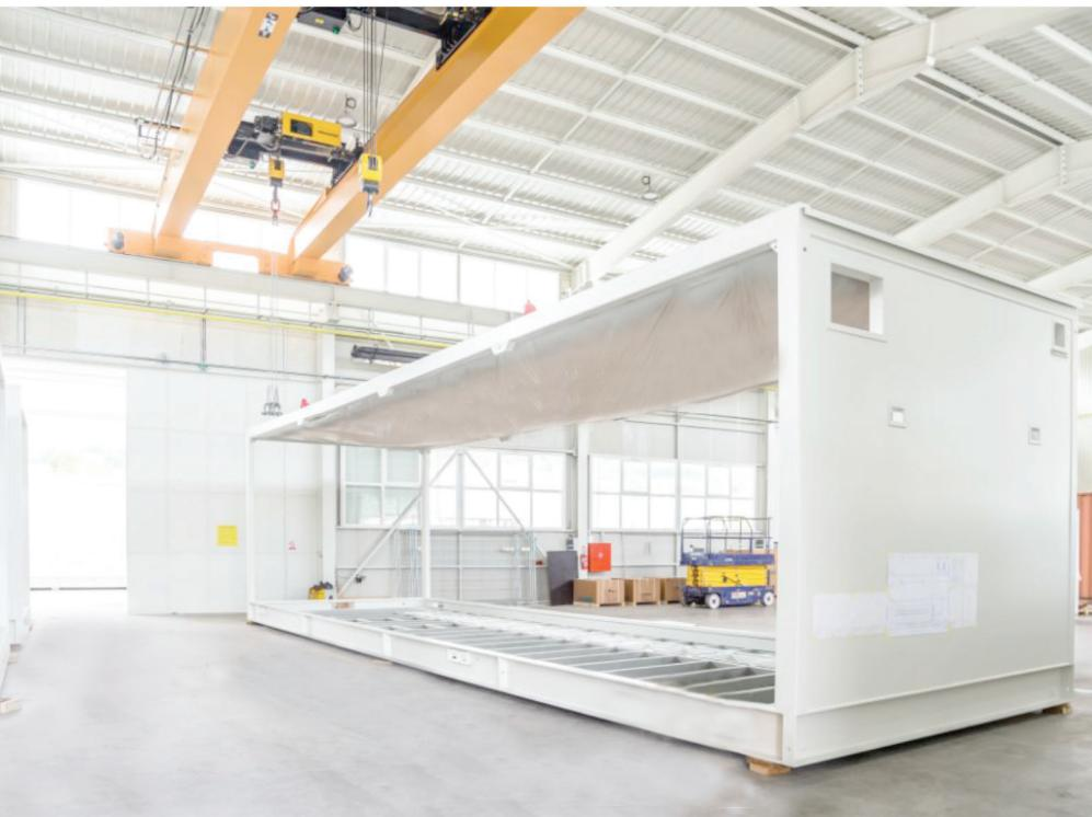
Die technische Module werden auf Kundenwunsch hergestellt und stellen besondere Anforderungen an Feuerwiderstand, Luft-, Wasserdurchlässigkeit, Explosionschutz, verstärkte Boden- und Dachlast, Schall- und Wärmedämmung.
